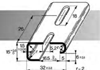
Guida supporto in acciaio, zincato a caldo con processo Sendzimir
