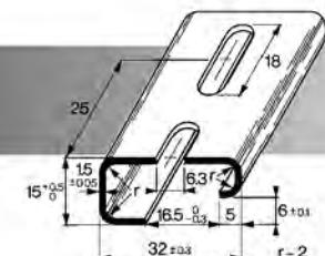
Guida supporto in acciaio, zincato a caldo con processo Sendzimir
