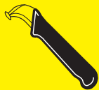
D3/3 Ontmantelings- messen voor dikke kabels
