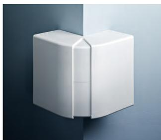
**Gelenk-Außeneck.** Für die formvollendete Eckumfahrung mit Verstellbereichen von  $-12^{\circ}/+32^{\circ}$ . Mit den schwenkbaren Außenseiten passen sich die Außenecken perfekt an jeden Winkel des Raumes an. Die Lösung für suboptimale Gegebenheiten.
