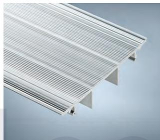
**Unterseite.** Wenn der Aufbodenkanal auf Teppichböden gelegt wird, bildet die geriffelte Unterseite einen gewissen Schutz vor dem Verrutschen. Langfristig empfiehlt es sich, mit einigen Streifen doppelseitigen Klebebands zu arbeiten oder den Kanal zu verschrauben.
