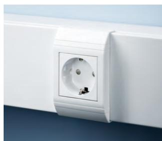
**Modulrahmen.** Für den Einbau von M45 Einbaugeräten. Einbau ab Kanalhöhe 40 (Breite 90 mm) möglich. Es bleibt viel Platz für die Leitungsführung. Einfache Rastmontage mit sauberer Schnittkantenabdeckung.
