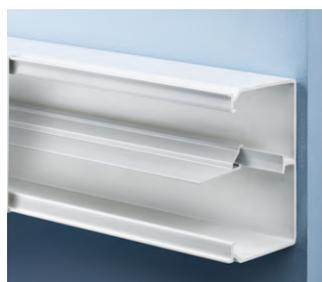
**Trennwand.** Trennwände dienen der übersichtlichen Aufteilung des Kanals und der Trennung einzelner Leitungsstränge. Die Montage erfolgt durch einfaches Aufrasten auf den durchgängig angeformten Montageschienen im Kanal-Unterteil.
