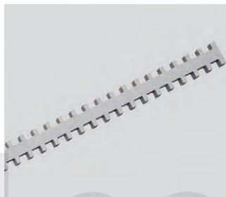
**Haltezunge.** Verhindert das Herausfallen der Kabel bei horizontaler Montage des Verdrahtungskanals und verbessert den Halt des Oberteils durch die Stabilisierung der Verdrahtungskanal-Lamellen. Der Haltekamm wird einfach zwischen zwei Verdrahtungskanal-Lamellen geschoben.
