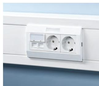
**Komplett-Steckdosen-Einheit KSE-M45.** Die M45 Einbaugeräte im Adapterrahmen für Kanäle mit 80 mm Oberteil verschaffen da viel Platz, wo vorher eine Geräteeinbaudose eingebaut werden musste. Beschriftung dank des horizontalen Beschriftungsfeldes möglich. Auch eine individuelle Bestückung ist realisierbar.
