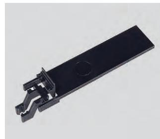
**Halteklammer.** Verhindert das Herausfallen bereits eingelegter Leitungen, geeignet für Verdrahtungskanäle ab einer Breite von 40 mm, die Halteklammer hat Schnittmarkierungen für die unterschiedlichen Breiten (43, 60, 80 und 100 mm). Montage in Abständen von 20-30 cm, abwechselnd links und rechts.
