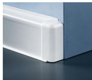
**Endstück.** Kanalenden werden sauber mit einem Endstück verschlossen – einfach aufstecken. Dabei ist zu beachten, ob es für die rechte oder linke Seite benötigt wird. An Kanten, die häufig mit Staubsauger in Berührung kommen, sollten die Endstücke fest verklebt werden.
