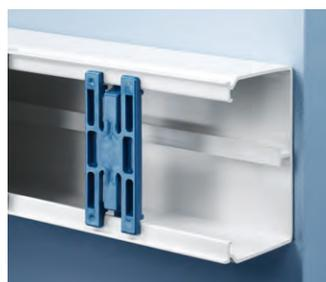
**Kabelhalteklammer.** Ab der Abmessung 40x60 sind vier frei verschiebbare Kabelhalteklammern (KHK) je 2 m Länge im Kanal-Unterteil eingerastet. Bei Deckenmontage empfiehlt es sich, zusätzliche Klammern einzusetzen.
