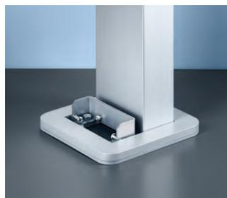
**Bodenanschlussplatte.** Grundelement bereits vormontiert und mit genügend Eigengewicht, damit die Säule steht. Kann bei Bedarf am Boden verschraubt werden – die Schraubbefestigungen bleiben unsichtbar.
