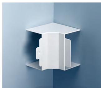
**Inneneck.** Durch die angeformten Laschen (bei Innen- und Außenecken, Flachwinkeln) werden die Kanaloberseite sauber geführt und Sägeschnitte gut abgedeckt. Formteile sparen wertvolle Montagezeit. Von 15x15 bis 60x200.
