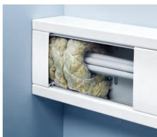
**Schallbarriere.** Ein Mineralfaserstrang mit 20 mm Durchmesser zum Selbstablängen. Dämmt rund 40 dB und sollte immer dort eingesetzt werden, wo Kanal-Systeme durch die Wand führen und eine Schallübertragung so weit wie möglich vermieden werden soll.
